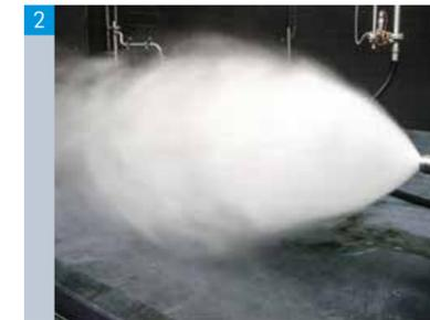
Durch die im Reaktor integrierte **WASSEREINDÜSUNG** können die für den Prozess optimale Temperatur sowie Gasfeuchte eingestellt werden. Auf ein zusätzliches Quenchsystem vor dem Reaktor kann verzichtet werden.
