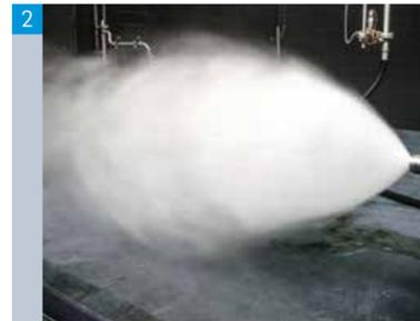
Le processus **D'INJECTION D'EAU**, intégré dans le réacteur permet de réguler la température et l'humidité des gaz de façon optimale pour le procédé, et rend inutile tout système de refroidissement supplémentaire en amont du réacteur.
