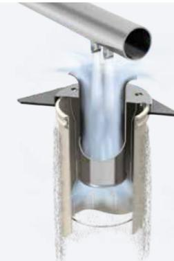
Le **SYSTÈME DE NETTOYAGE IMPULS** de Scheuch, doté de doubles buses, assure un nettoyage homogène sur toute la longueur des manches filtrantes, permettant de réduire la consommation d'air comprimé.
