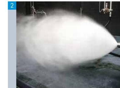
Le processus **D'INJECTION D'EAU**, intégré dans le réacteur permet de réguler la température et l'humidité des gaz de façon optimale pour le procédé, et rend inutile tout système de refroidissement supplémentaire en amont du réacteur.
